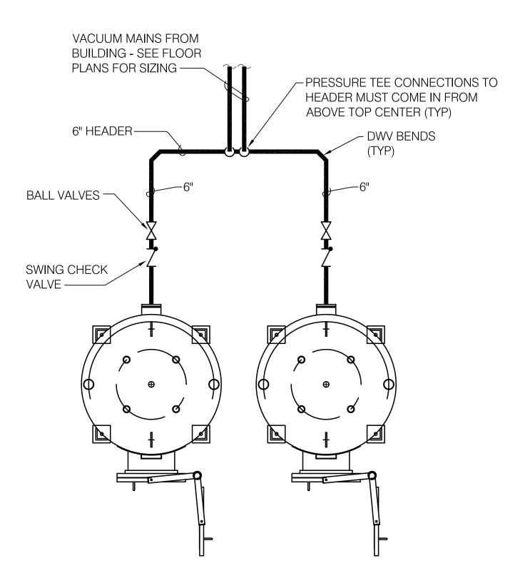
VACUUM WASTE COLLECTION TANK INLET CONNECTION DIAGRAM
