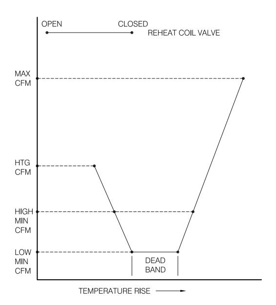
TERMINAL UNIT - SEQUENCE OF OPERATION SCALE: NTS
